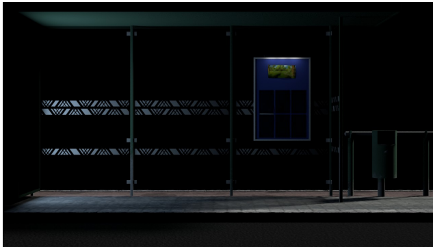
Kuva 20. Proviva-projektin bussipysäkin diffuse-renderöintikerros kerrottuna suoran valaistuksen renderöintikerroksella.
