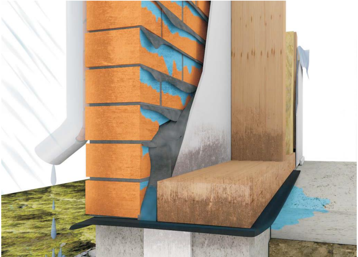
Kuva 5. Havainnekuva tiilikuorimuurauksen tuuletusraon alaosan tukkeutumisesta ylimääräisestä muurauslaastista (Hometalkoot.fi).
