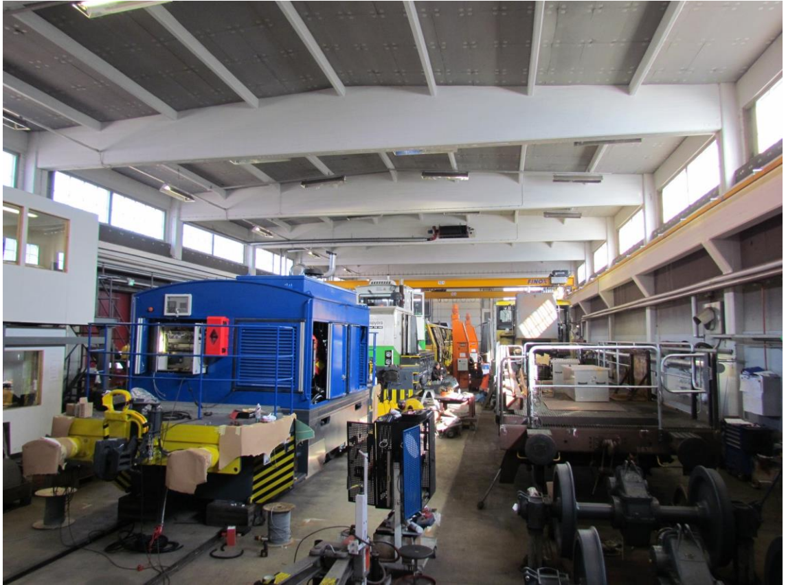
Kuva 3. Vasemman puoleisella raiteella on lähimpänä rakenteilla oleva uusi veturi, keskimmäisenä korjauksessa oleva veturi ja perällä korjauksessa oleva ratatyökone. Oikean puoleisella raiteella on tavaravaunu huolettavana, ratatyökone raidelevyden muutostyössä ja sen takana näkymättömissä isossa huollossa oleva ratatyökone.
