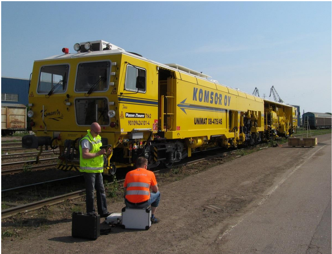
Kuva 4. Juuri laivasta puretun uuden ratatyökoneen liikennekelpoisuustarkastus on alkamassa Kotkan satamassa.
