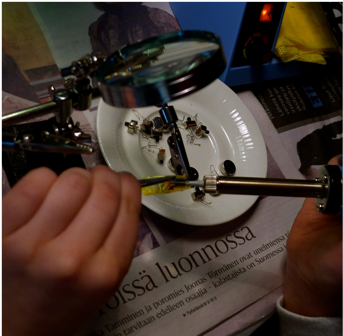
Kuva 20. Johtojen kolvaamista työhuoneella
