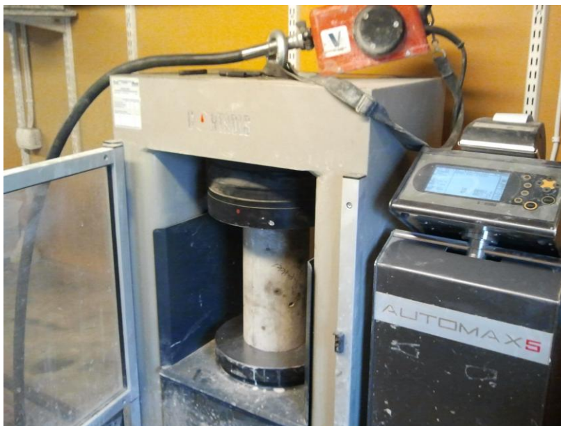
Kuva 8. Puristuslujuuden mittaaminen lieriöpalkista
