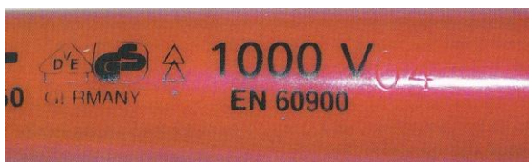
Kuva 7. Jännitetyökalun standardin SFS-EN 60900 mukainen merkintä (Mäkinen 2010, 20).
