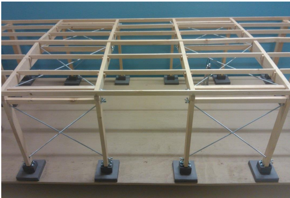
Kuva 2. Mastopilarihallin vinojäykisteet ja juurikiinnitykset
