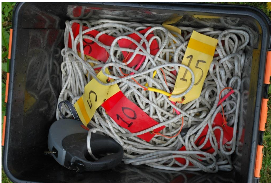
Figur 12. En 100 meters graderad dyklina som användes vid testnigen av att bestämma täckningsgrader.
