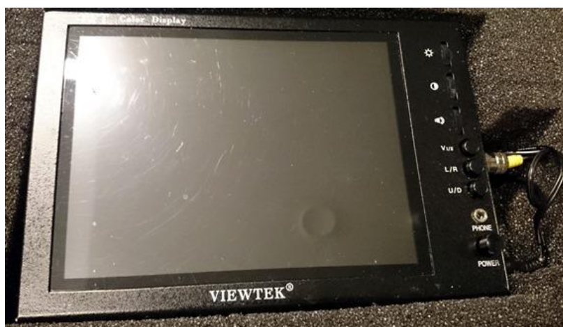
Figur 9. VIEWTEK TFT color display, bilden som drop-videon fångar upp skickas till den här displayen.
