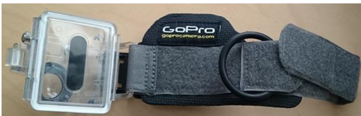
Figur 15. GoPro vattentätt skyddshölje med rem att fästa kameran runt handleden med.
