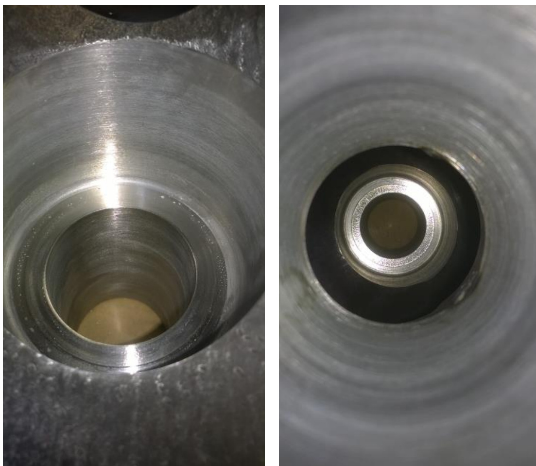
Kuva 39. Pinnoitettu alue valmiiksi koneistetussa kappaleessa.
