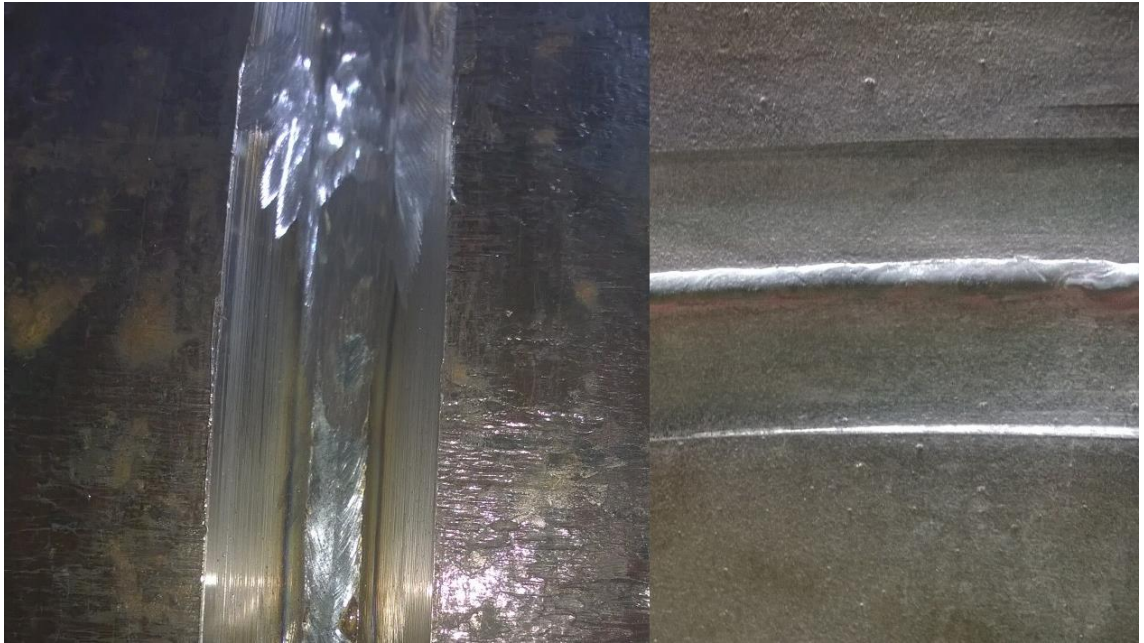
Kuva 36. Pohjapalko railonpuolelta ja putken sisäpuolelta kuvattuna.
