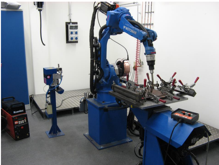
Kuva 14. Teollisuusrobottiin liitetty hitsausvarustus (18).
