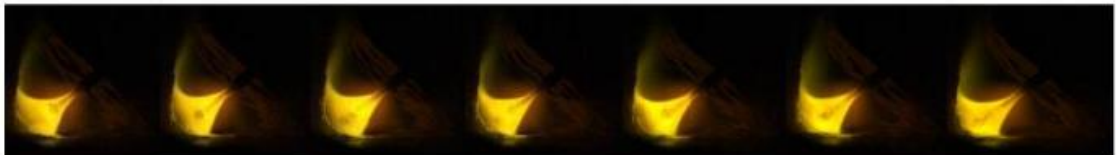
Kuva 6. Suurnopeuskameran kuvaa lisääineen siirtymisestä kuumakaari alueella hitsattaessa (6).
