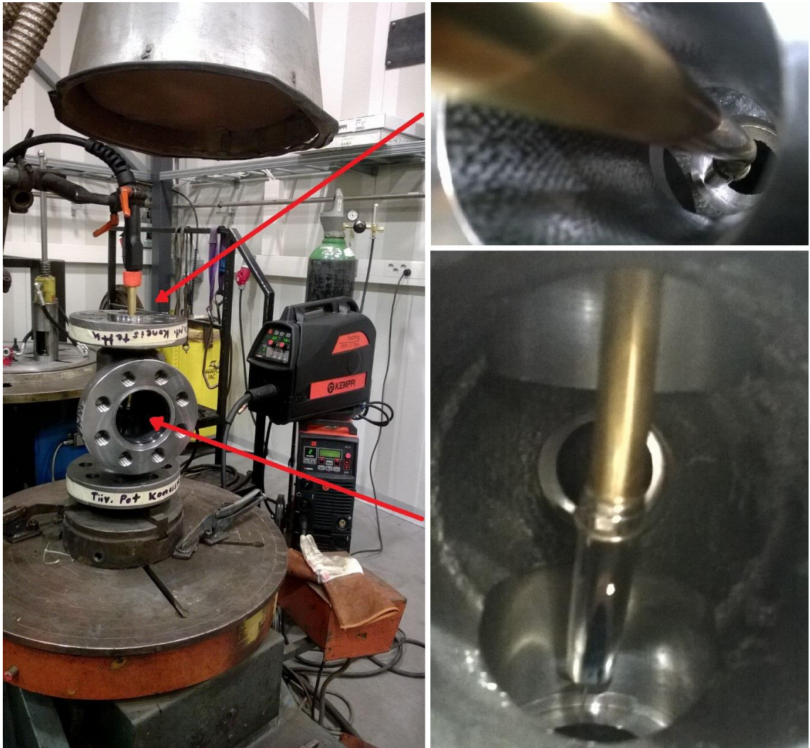
Kuva 29. Kappaleen kiinnitys ja hitsauspolttimen asema.
