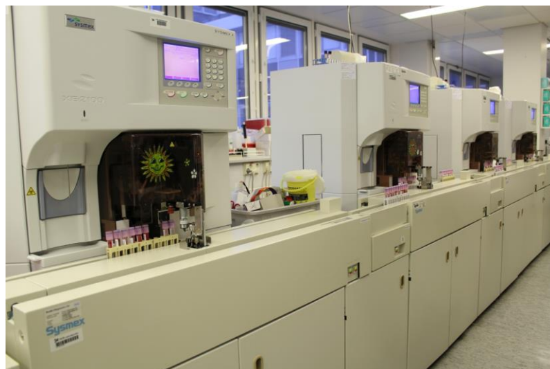
Kuvio 7. Sysmex XE-2100 -analysaattori Meilahden sairaalan automaatiolaboratoriossa. Kuvassa on neljä yksikköä.
