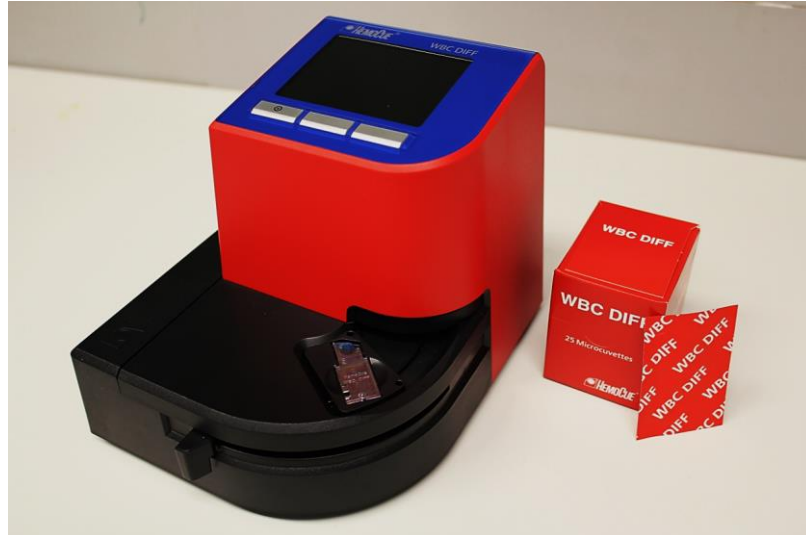
Kuvio 6. HemoCue® WBC Diff -vieritestianalysaattori ja yksittäispakatut näytekyvetit.
