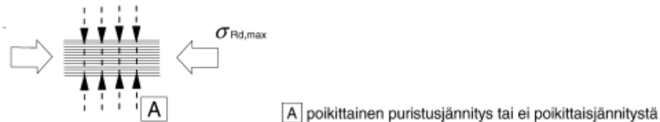
Kuvio 18. Puristuskaistan mitoituslujuus on \sigma_{Rd,max} = f_{cd} , kun kaistassa ei esiinny poikittaista vetoa. [5]
