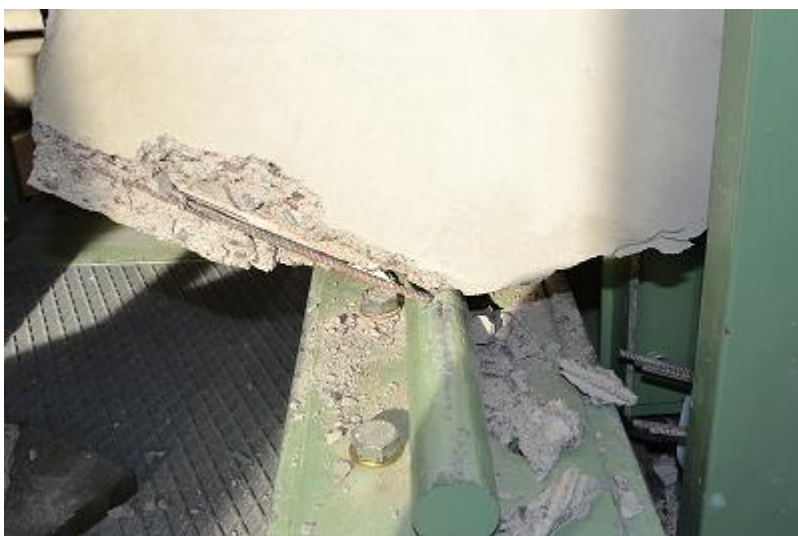
Kuva 11. Koekappale 3: Alapinnan teräkset eivät katkenneet tuella B
