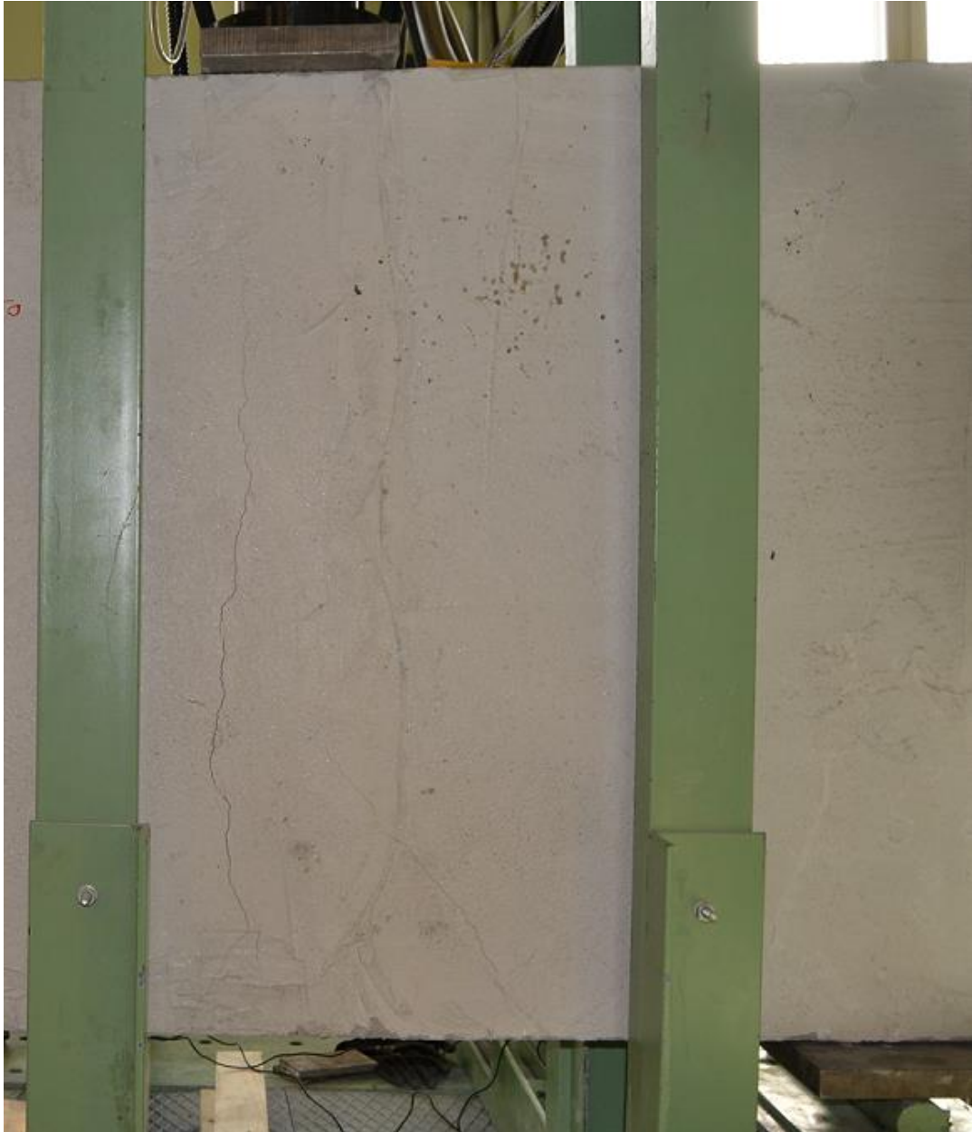
Kuva 9. Koekappale 3: Keskelle muodostunut halkeama (173,6 kN)
