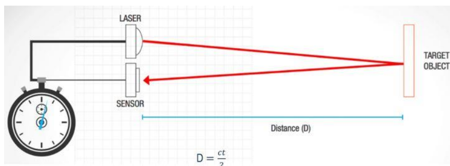
Kuvio 2. LiDar-teknologian toimintaperiaate (Notaro 2021)
