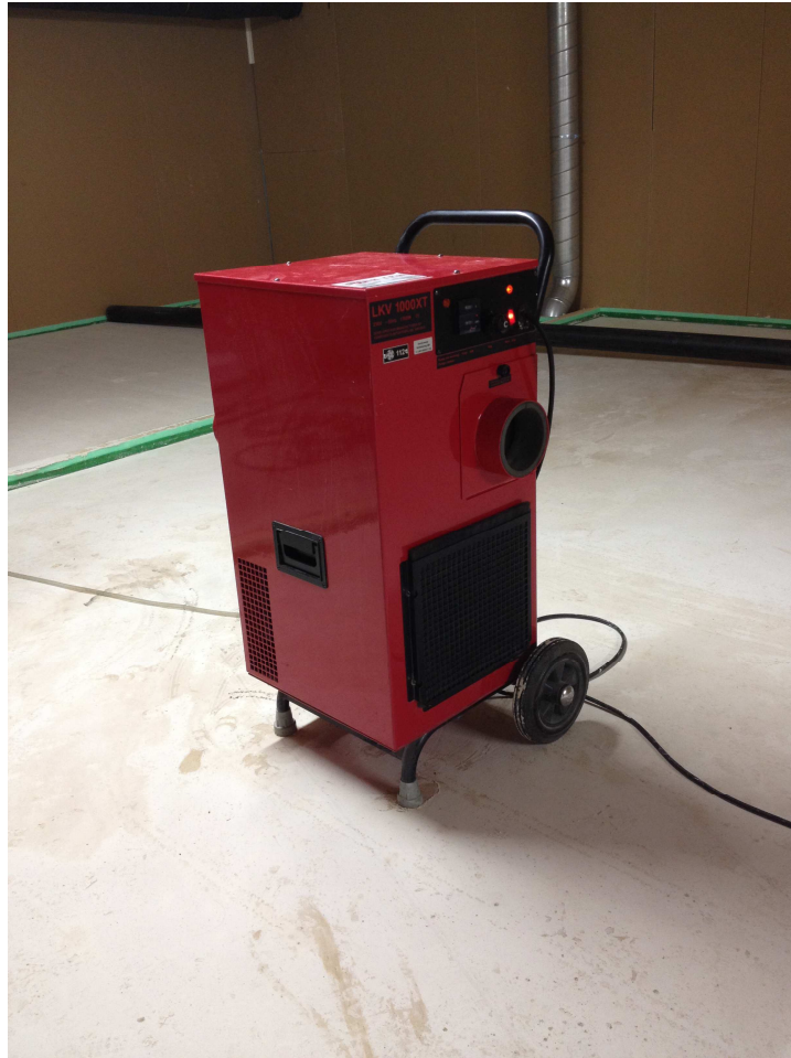
Figur 23. Avfuktningmaskinen som användes vid exempel objektet var av modell LKV 1000XT. (Dennis Hindersson)
