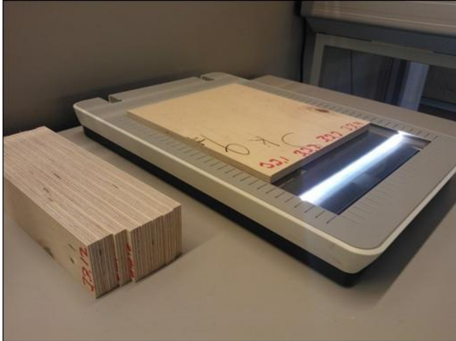
KUVA 5. Koekappaleiden skannaus. Skanneriin mahtui kerralla neljä kappaletta rinnakkain.
