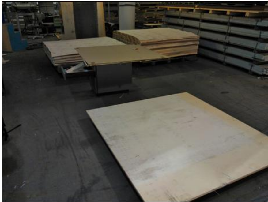
KUVA 4. Viilujen käsinpunnitus. Vaa'an päälle rakennettiin viiluarkin kokoinen kehikko. Viilut punnittiin yksitellen ja tulokset kirjattiin Excel-taulukkoon.
