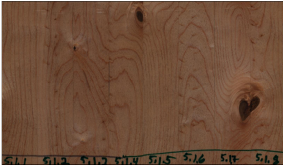
KUVA 6. Vinosyisyyden esiintyminen oksien lähialueella.
