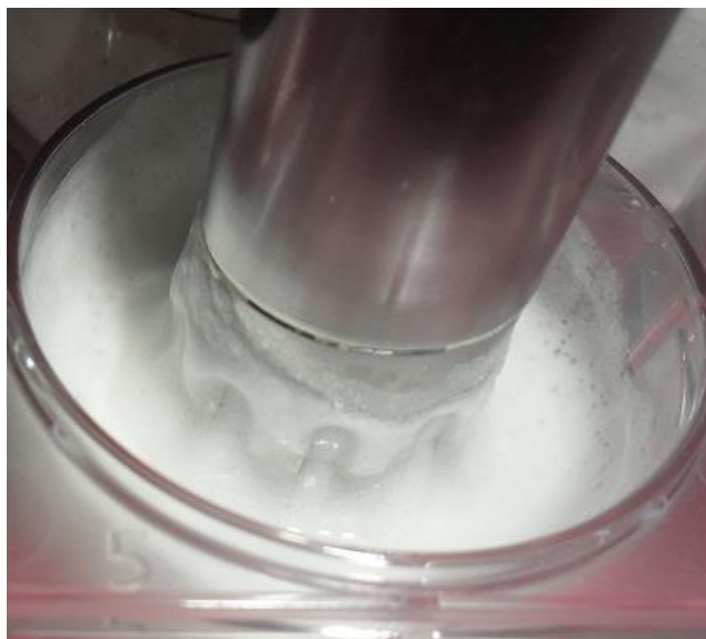
Kuva 19. Geelin vaahdotus kuoppalevyllä Ultra-Turrax T25 -homogenisaattorilla.
