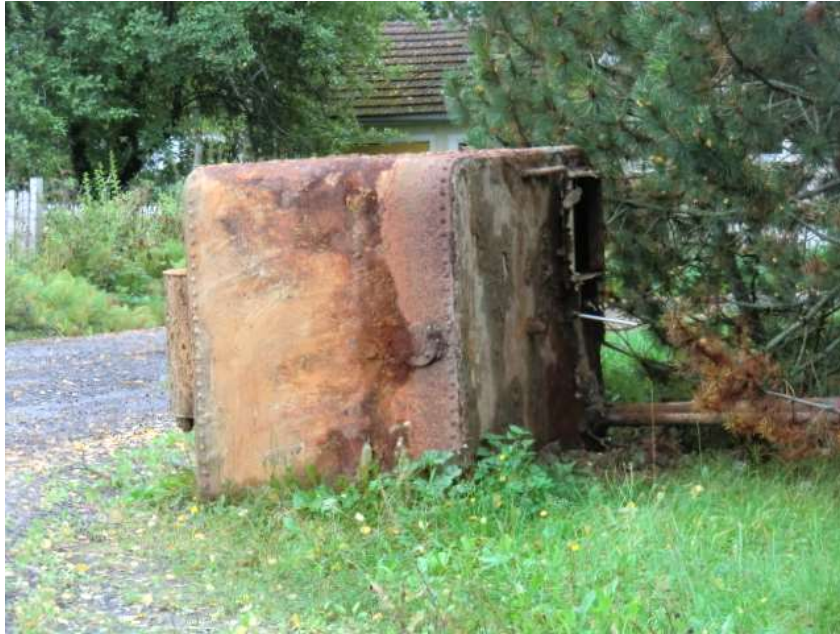
KUVA 1. Vanha maanalainen lämmitysöljysäiliö, joka on kaivettu ylös maasta (TANKKI-hanke 2014)
