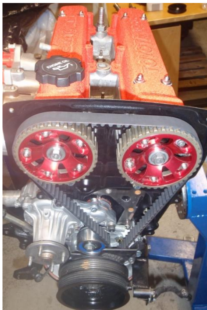
Kuvio 2. DOCH-sylinterikannella varustettu moottori.
