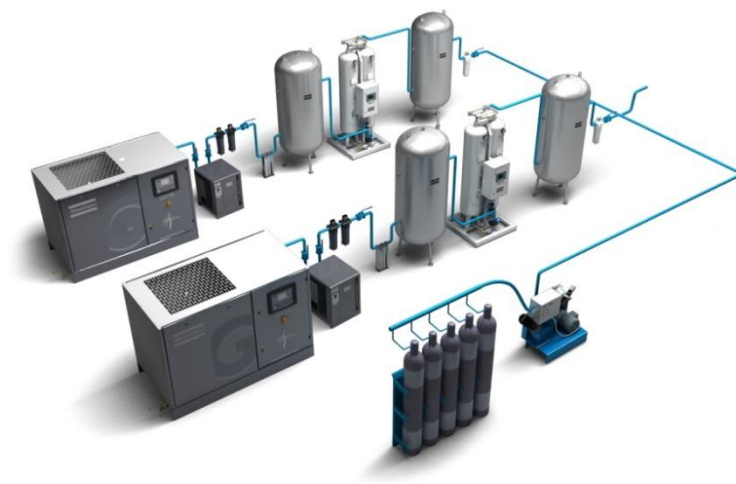
KUVA 4. Lääkkeellisen hapen (93 %) syöttöjärjestelmä, jossa 2 happirikastinjärjestelmää ja pulloituslaitteisto (Oy Atlas Copco Ab 2013b)
