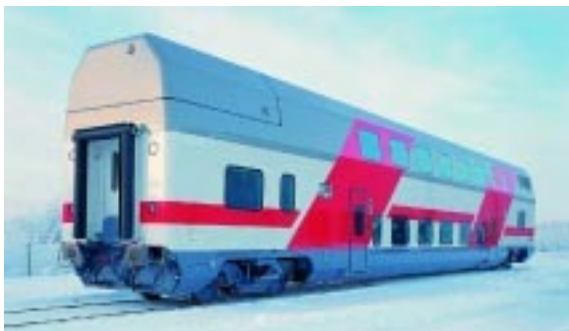
Kuva 3. Talgon kaksikerroksinen InterCity –vaunu [2]
