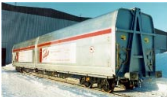
Kuva 4. Talgon tavaravaunuosaamista, kuvassa siirtoseinävaunu [2]
