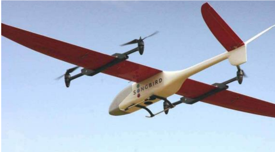
Kuva 2. VTOL-tekniikalla toimiva Songbird-ilma-alus [10, s. 8.]
