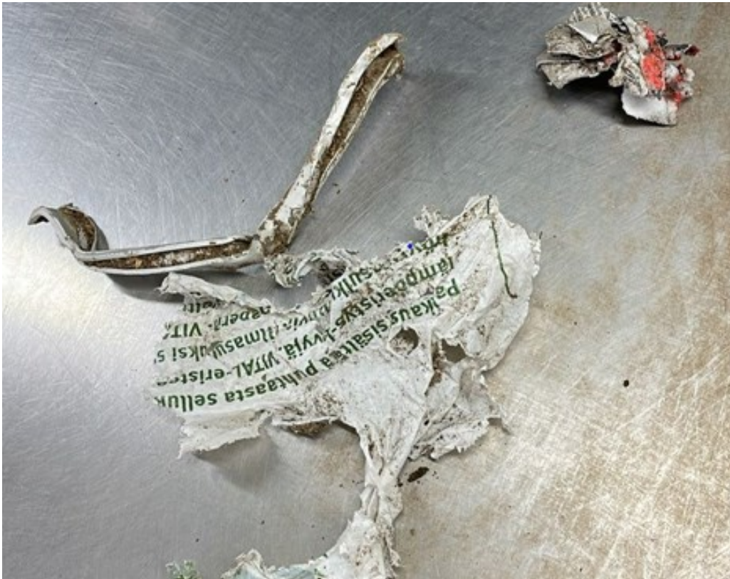
Kuva 6. Vanajan voimalaitokselle tuodun kierrätyspuukuorman seasta löytyneitä epäpuhtauksia
