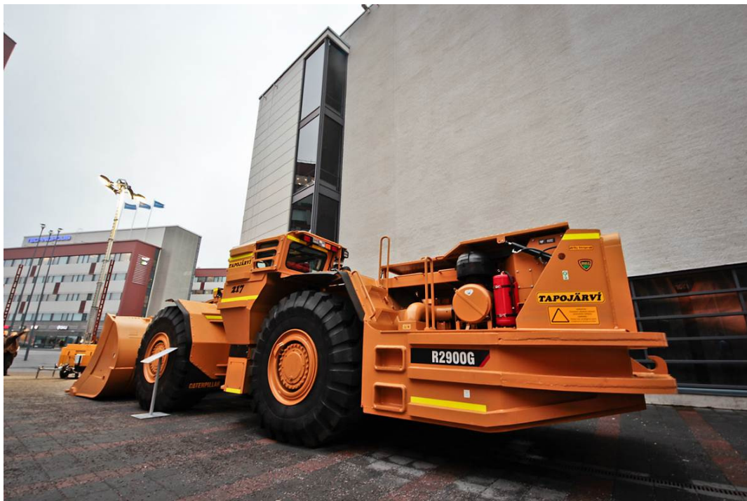
Kuva 6. Pyöräkuormaaja, maanalaiseen lastaukseen (Laapotti 2013)
