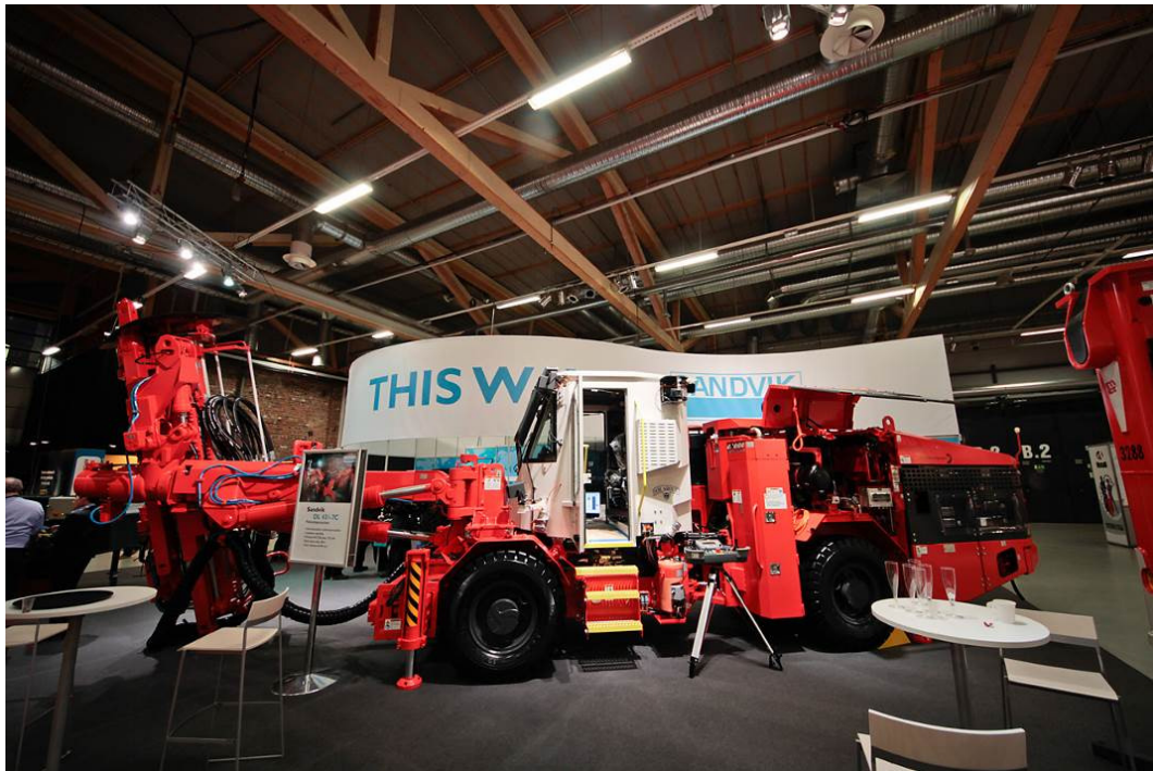
Kuva 1. Maanalainen tuotantoporavaunu (Laapotti 2013)
