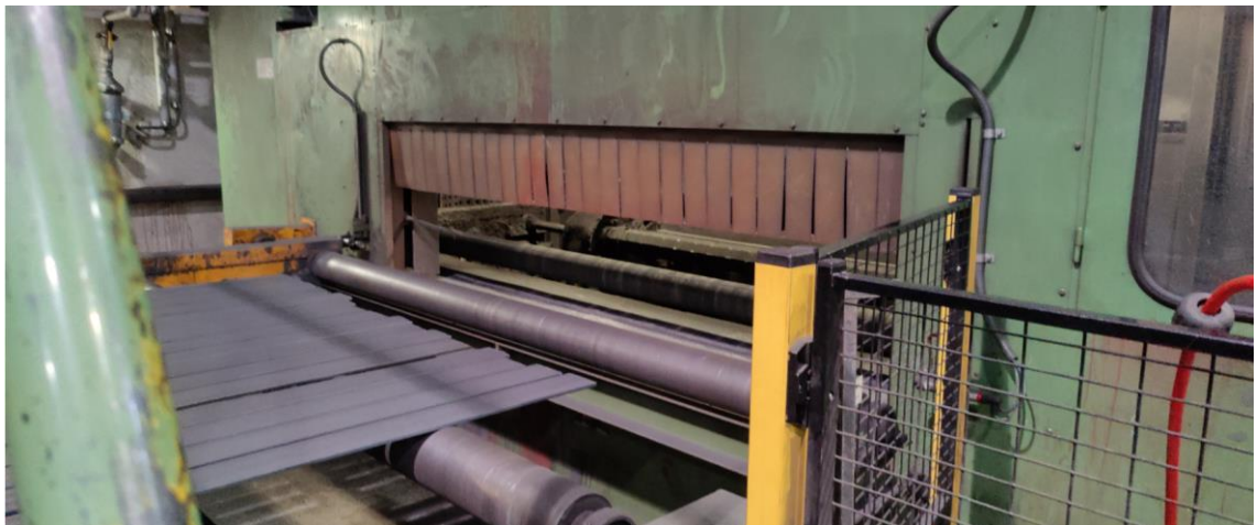
Kuva 7. Tuotantolautta etenemässä maalausyksikköön.
