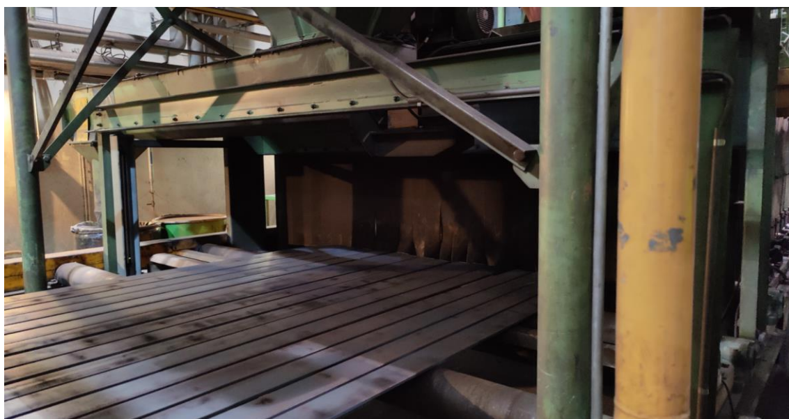
Kuva 6. Tuotantolautta etenemässä sinkouksyksikköön.
