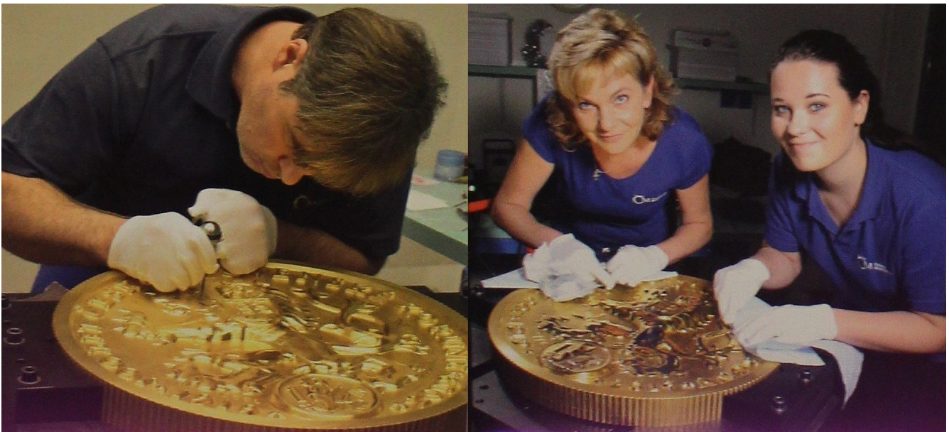
Kuva 4. Rahan tunnuspuolen kaiverrustyö ja sen jälkeen seurannut kiillotusvaihe kuvattuna rahamuseon esittelytaulussa. Kuva: ČNB, kuvan käsittely: Jorma Imppola SeAMK.
