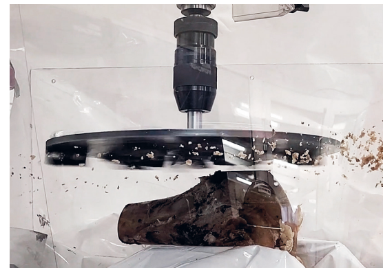
Kuva 3. Päänkäsittelyä koelaitteella ja kokeen tuloksena syntynyttä tuotetta.
