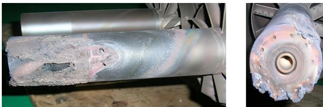
Kuva 26. Esimerkki DLN-polttoainesuutinten vahingoittumisesta flame holding -ilmiön seurauksena (Hydrogen as a fuel for gas turbines 2021).
