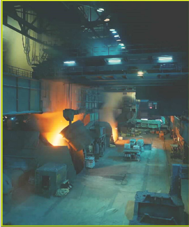
KUVA 20. Rautavaunu- ja nosturiliikennettä konvertterin etupuolella (5, s. 11)
