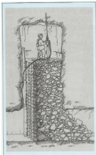
Kuva 2. Nousuajo rakentamalla (Räjäytystyöt, Vuolio ja Halonen 2010, 237)
