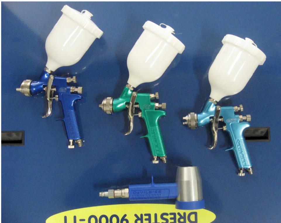
KUVIO 24. Vasemmalta oikealle Devilbiss maaliruiskut GTi Pro, PRi Pro ja GTi-W. Ruiskujen alla maalikuivain Devilbiss DMG-501-K.
