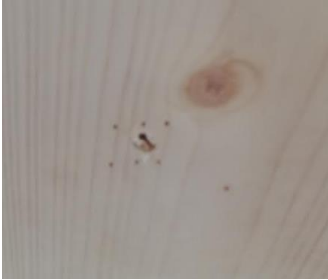
KUVA 26. Piikkimittaus kolme kertaa samasta mittauskohdasta.
