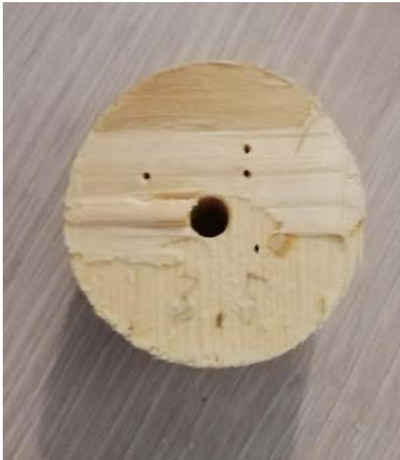
KUVA 34. Näytepala, johon jäi pieni osa lamellia liimasauman toiselta puolelta ja liimaa.
