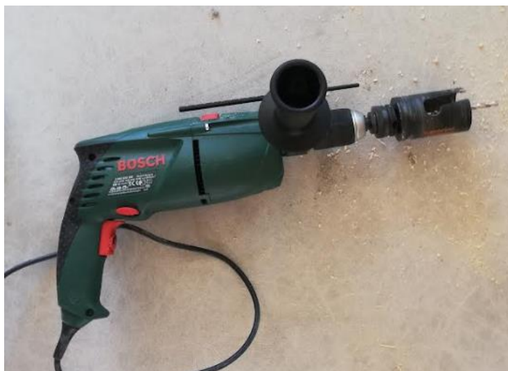
KUVA 16. Näytepalojen ottamisessa käytetty pora ja reikäsaha.
