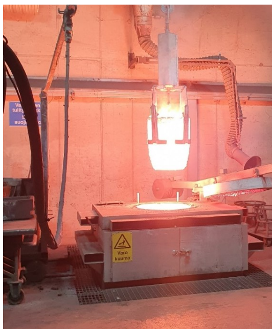
Kuva 3. Uunista nostettu 1450 °C upokas.
