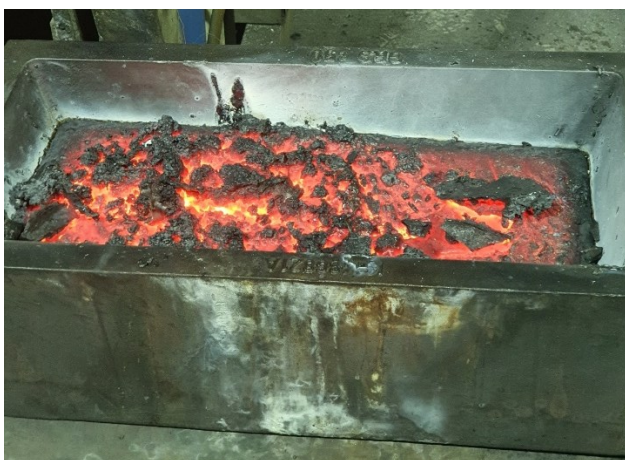
Kuva 5. Uunista tullut näyte kokillissa.
