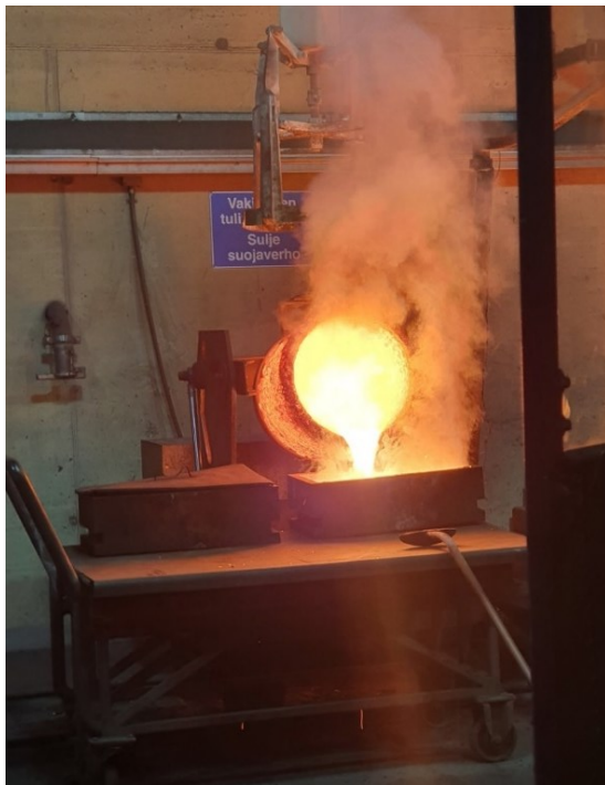
Kuva 4. Sulaneen näytteen kippaus kokilliin.
