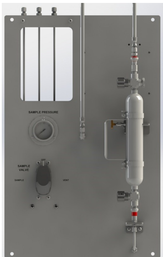
Kuva 10. 3D-Malli näytteenottopaneelista. Projektia varten on tehty muutokset.
