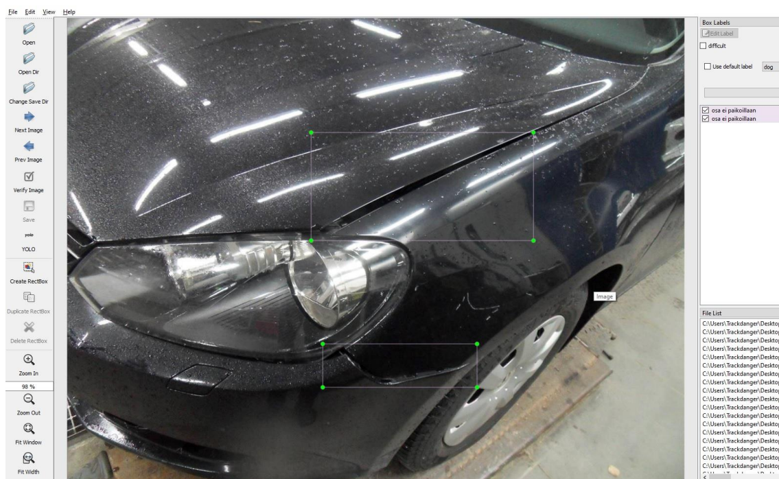
KUVA 7. Esimerkkikuva vaurioluokasta osa pois paikoiltaan (K-Auto Oy)
