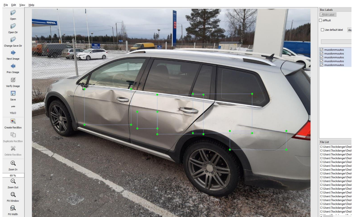
KUVA 6. Esimerkkikuva vaurioluokasta muodonmuutos (K-Auto Oy)
