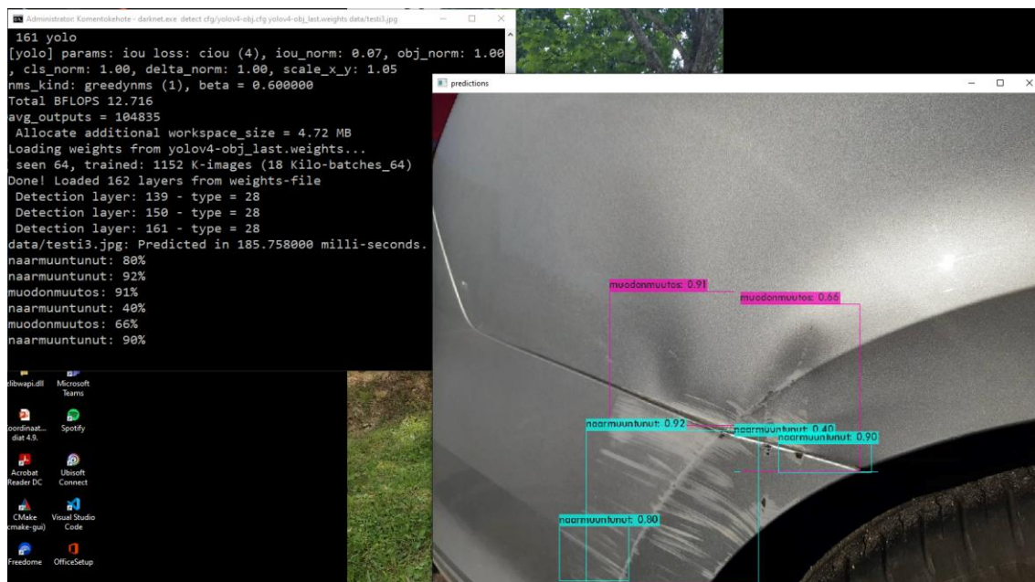
KUVA 14. Oikean takakyljen vaurion tunnistus
