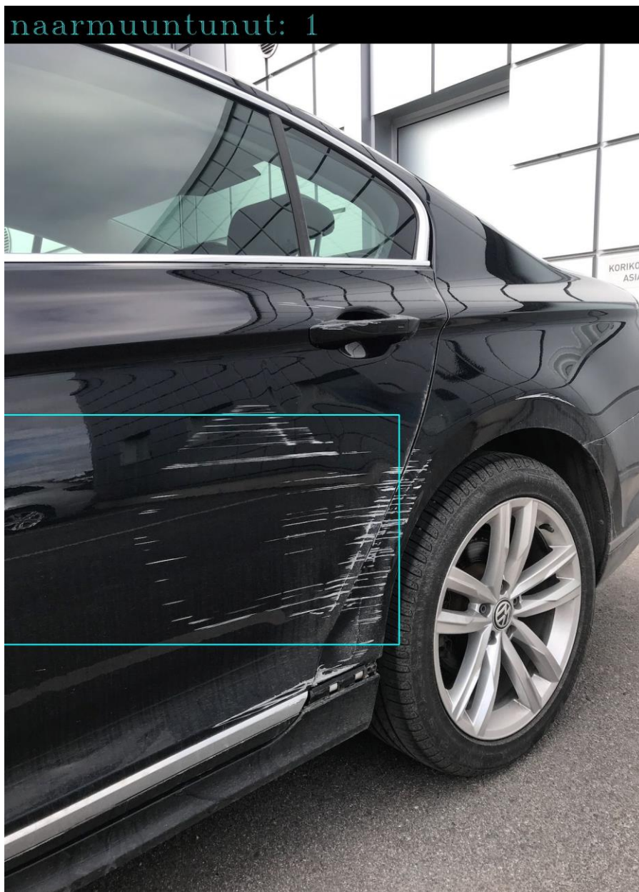
KUVA 24. Passatin kyljen naarmuvaurion tunnistus
