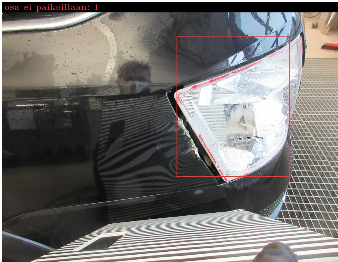
KUVA 22. Kaikkia kuvassa näkyviä vaurioita ei tunnisteta
