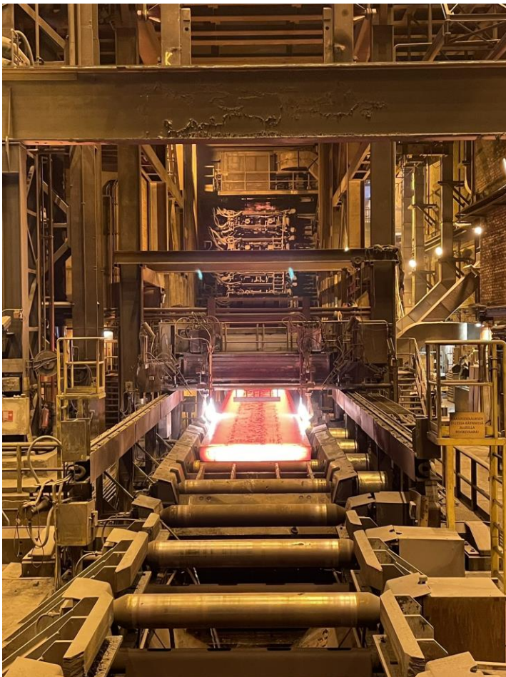
KUVA 6. Kaasuleikkauskone aihion kanssa
