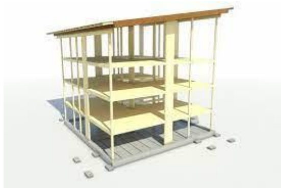
Kuva 5. Pilari-palkkijärjestelmä mahdollistaa avarat huonetilat (Mustonen 2017).
