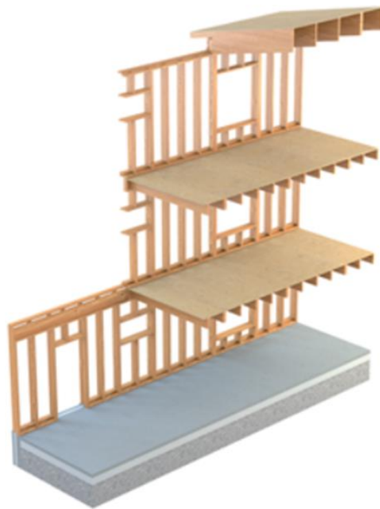
Kuva 3. Rankarunkojärjestelmän toimintaperiaate (Puuinfo 2020).
