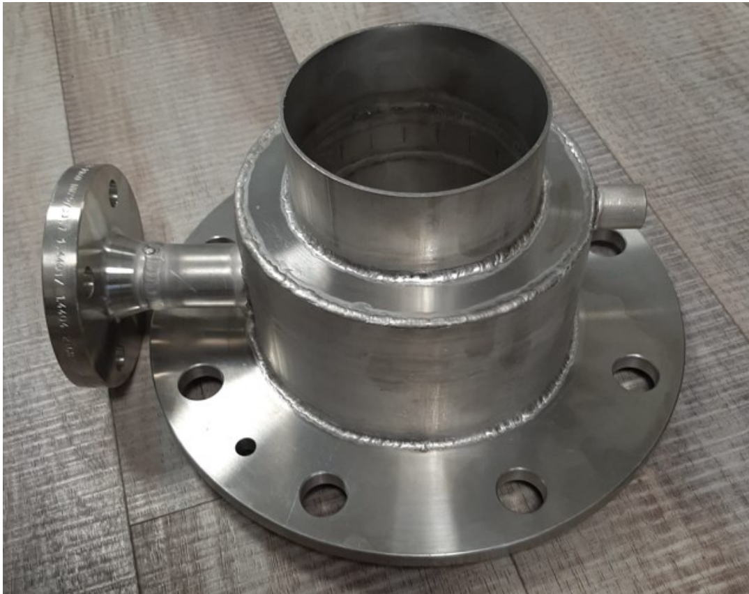
Kuva 8. Jauhekostuttimen yläosa hitsattuna ja peitattuna.
