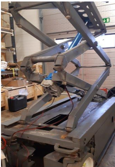
Kuva 20. Henkilönostimen sähköistys (Norrhydro 2022a)
