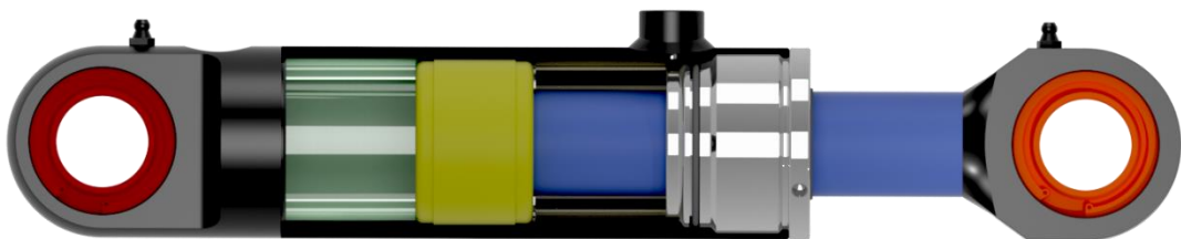
Kuva 2. Yksitoimisen hydraulisyylinterin rakenne (Hydroline 2022)
