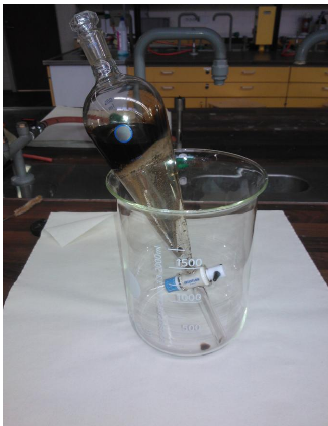
Kuva 4 Öljy-vesi uutto erotussuppilossa
