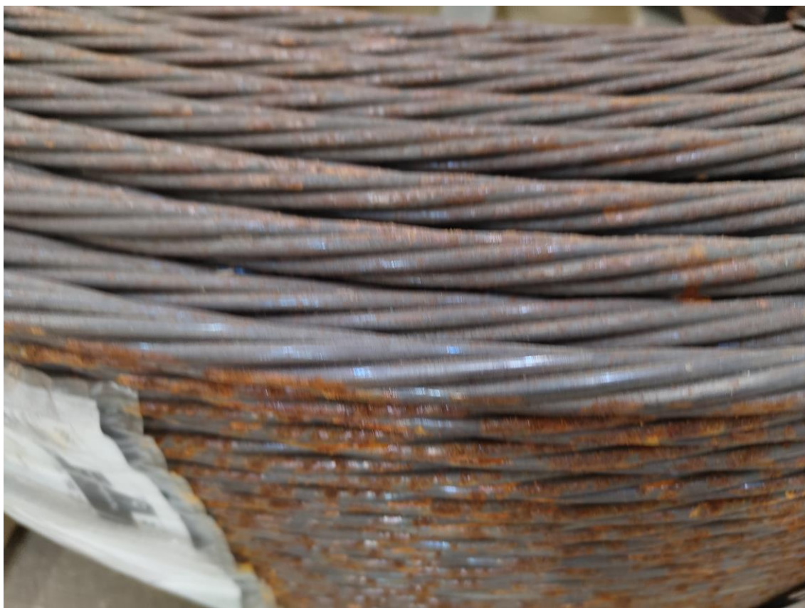
KUVA 6. Vaijeri on punottu paksuista terässäikeistä
