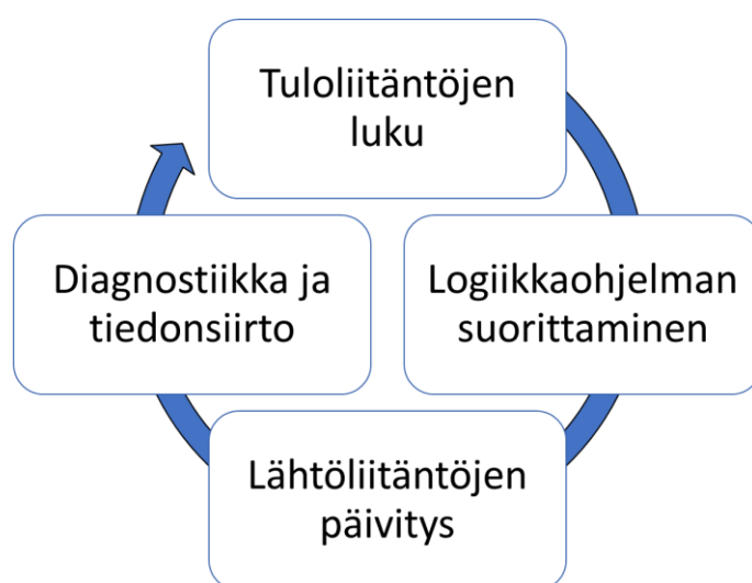
Kuva 26. Logiikkajärjestelmän ohjelmasykli (mukaillen Dey & Sen 2022, 29)
