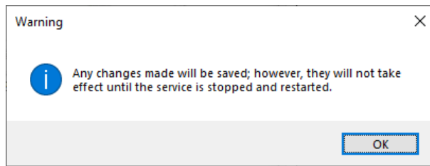
Kuva 45. SQL-palvelu on käynnistävä uudelleen asetusten voimaan saattamiseksi
