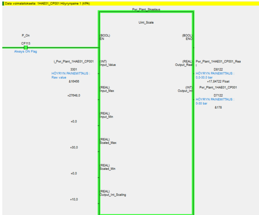
Kuva 24 . FB-toimintolohko skaalaukselle tikapuu-ohjelmoituna
