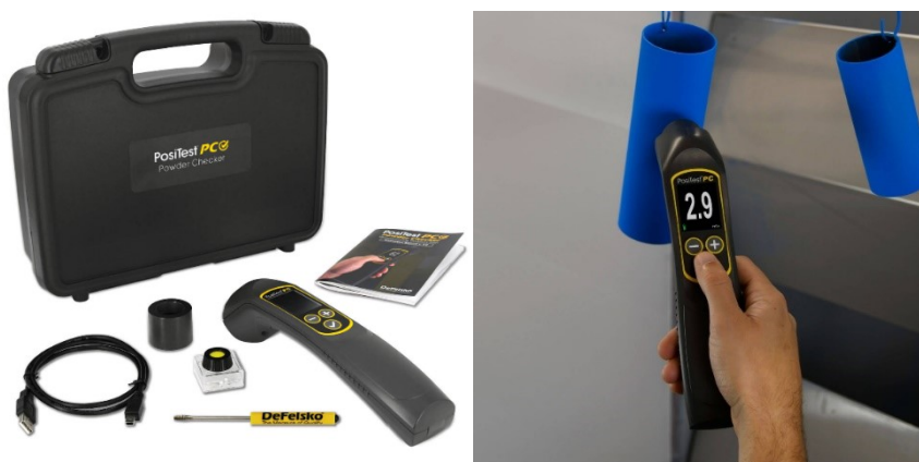
Kuva 30. Maalikalvon mittauslaite. Non contact mittari kalvonvahvuuden mittaamiseen. (Delfesko, 2022)
