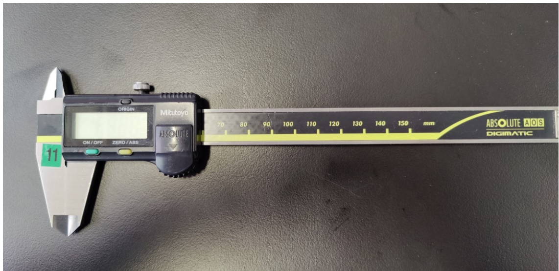
Kuva 11: Työntömitta väritarrajärjestelmän mukaisella tarralla
