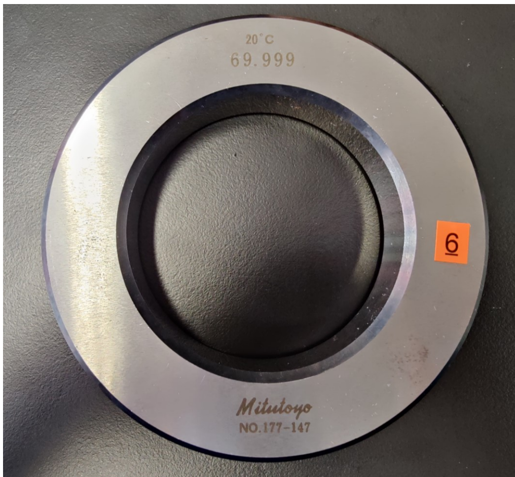
Kuva 2. Meconetilla oleva mittanormaali (Rengastulkki)
