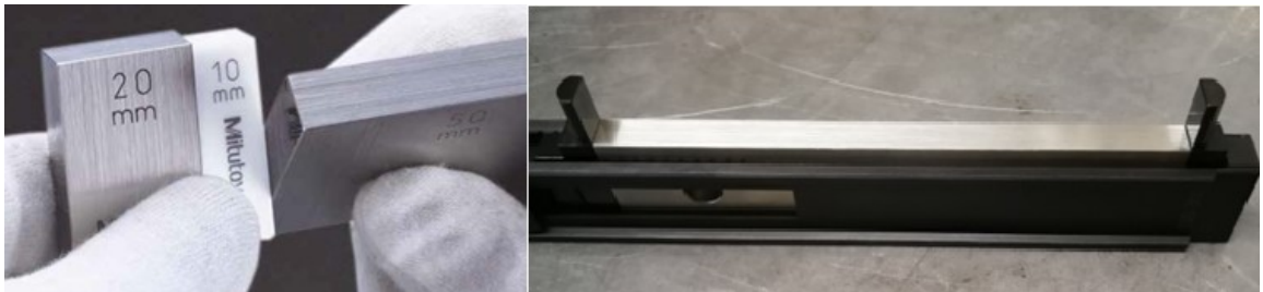
Kuva 12: Ulkomitta mittapaloilla (vasen) ja sisämitta liitântäsarjan avulla (oikea) [20]
