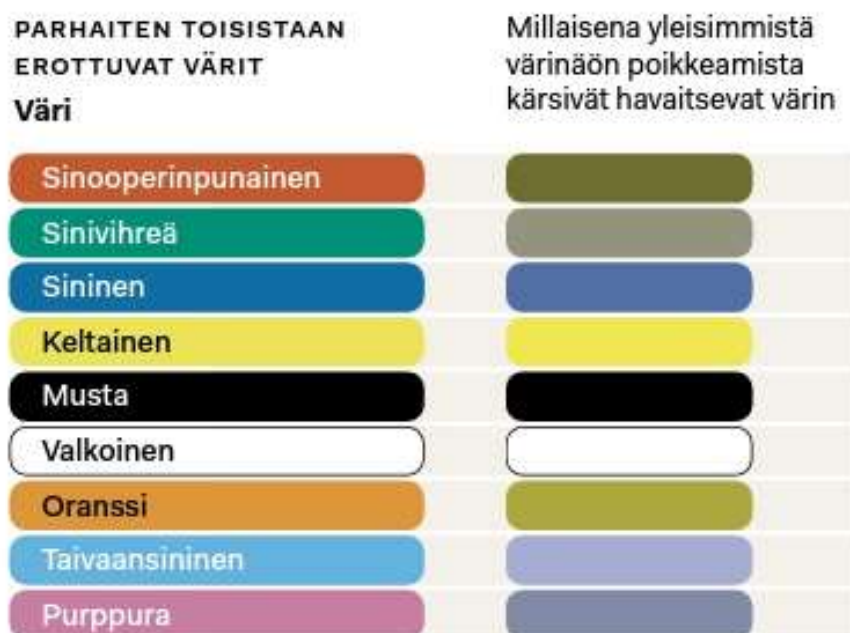
KUVA 19. Toisistaan parhaiten erottuvat värit ja niiden vastaavat havainnot väripoikkeamissa (Koponen ym, 2016, 110, muokattu).
