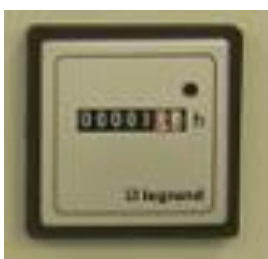
Kuva 11: Käyttötuntimittari. (Lindborg sähköposti 25.3.2014)
