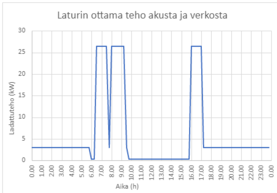
KUVAAJA 18. Sähköajoneuvojen ottama teho tosi tilanteessa
