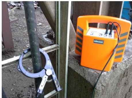
Kuva 40. Lähetin lähettää signaalia kaapeliin pihdin avulla
