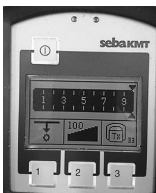
Kuva 43. Vastaanotin havaitsee kaapelin, mutta signaali on liian vahva
