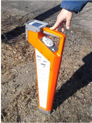
Kuvat 24. Easyloc-kaapelitutkan vastaanotin
