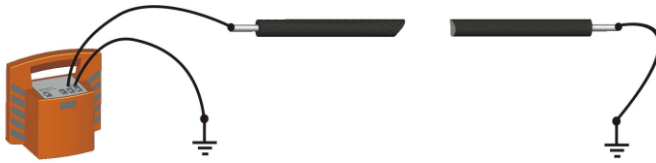
Kuva 27. KytKentä 1: Signaali kulkee vaihejohtimen kautta ja palaa maapotentiaalia pitkin [33, s. 15]
