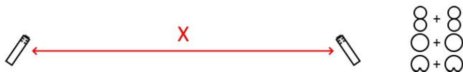
KUVA. 16 A/B. Mikrofonit A ja B asetetaan tilaan samalle etäisyydelle äänitettävästä kohteesta. (Alasalmi 2022)
