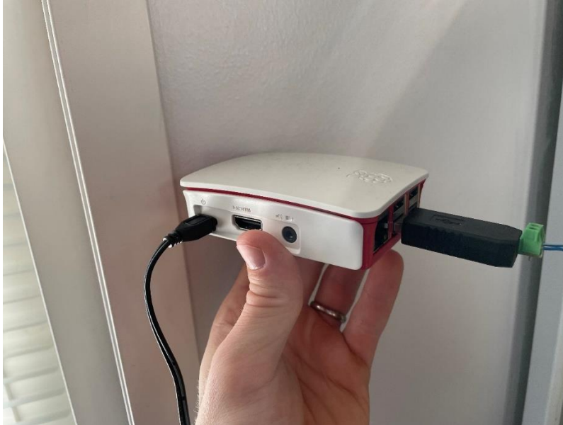
Kuvio 12: Raspberry Pi ja Modbus-USB adapteri
