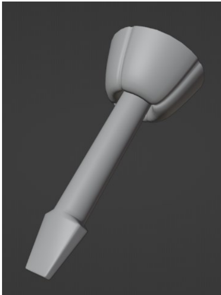
Kuva 18. Valmis raskasmalli ruuvimeisselistä, joka on upotettu robotin nenään.
